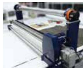
Kaschier Tisch - eine einfache Abschnievorrichtung weiter entwickelt
