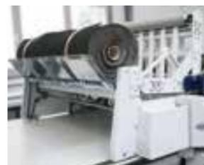
Einbevorrichtung für automatisches Einlegen der Stoffballen
