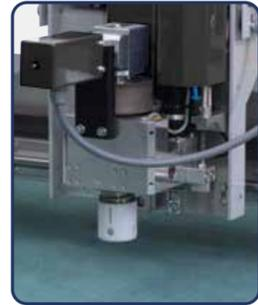
Zur Erfassung und zur Visualisierung werden optische Geräte wie Kamera und Projektoren verwendet. Das OT1 Tool ist ein auf Leder perfekt abgestimmtes Schneidwerkzeug. Die integrierte Reinigungsbürste garantiert einen prozesssicheren Ablauf für die optischen Geräte. Auch die Lebensdauer der Scheidunterlage verlängert sich deutlich.
